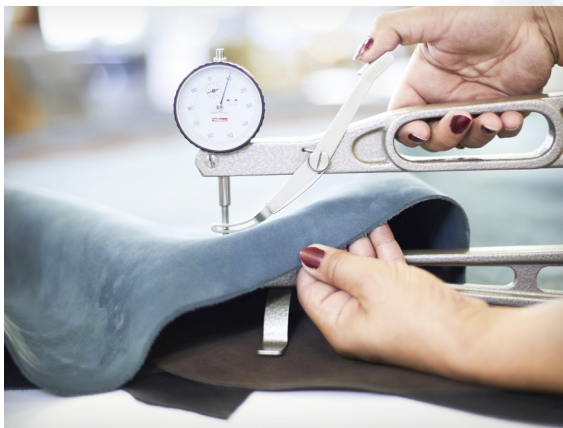
Messung der Lederdicke in den Lemaitre-Werkstätten
